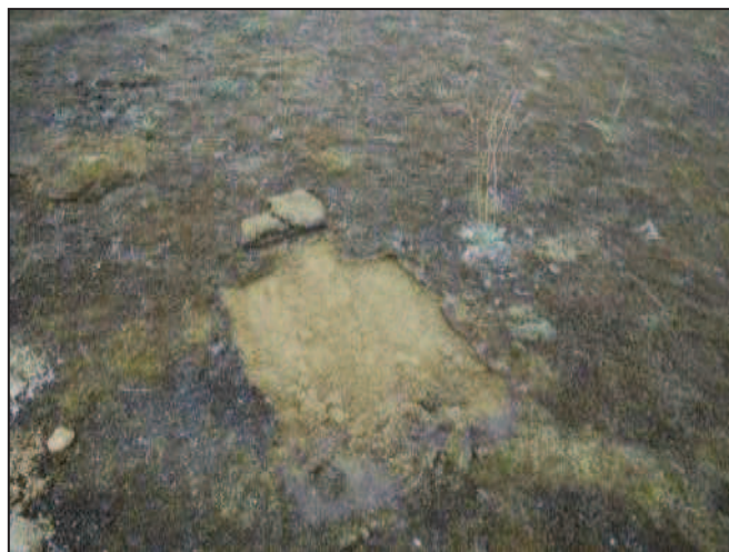
Schiste stabilisé visible une fois la mousse décapée.
