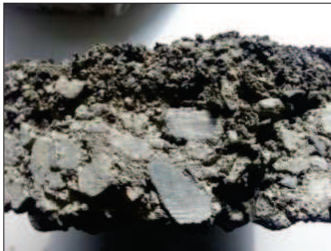
Échantillon d'enrobé sur laquelle l'analyse a été réalisée.
