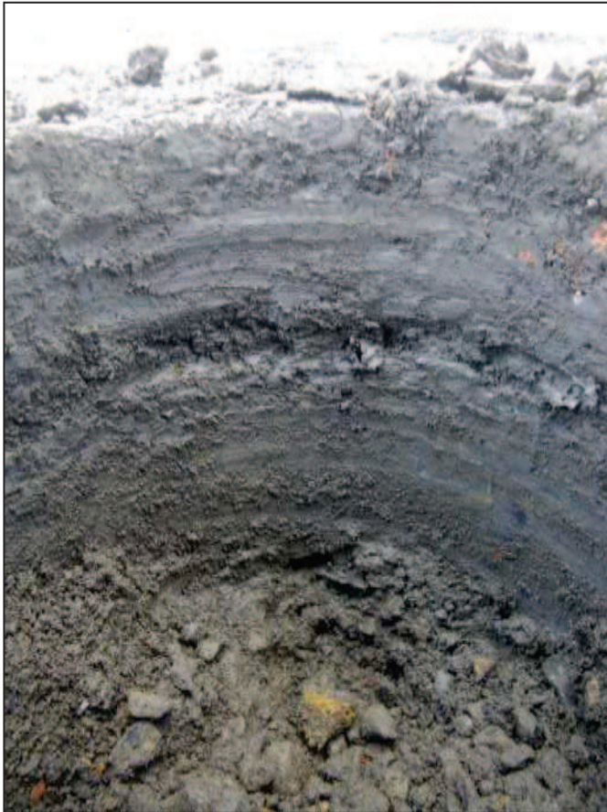
Profil de tupe 1 : grave de fondation cimentée
